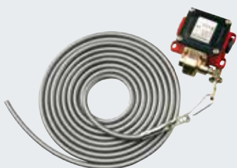
Выключатель с тяговым шнуром из пластмассы Возможен монтаж в вертикальном или горизонтальном положении, отлитый под давлением алюминиевый корпус, IP 65, длина шнура 4 м
