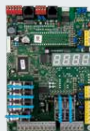
Плата расширения для блоков управления: BK 150 FU E-1 (E FU H) AK 500 FUE-1 (E FU H)
