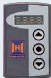
Внешний элемент управления для FUE-1 для простого управления и программирования, может устанавливаться независимо от блока управления, такие же клавиши, как и на блоке управления, 4-позиционный 7-сегментный дисплей
